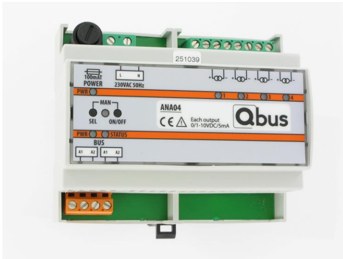
Figure 1 : module de variateur analogique ANA04
